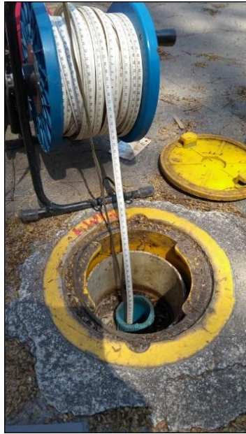
Figura 24. Monitoramento do nível d'água durante o ensaio hidráulico.
