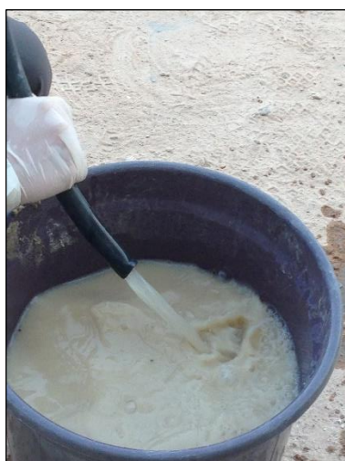
Figura 18. Destaque para a coloração da água removida dos poços de monitoramento.
