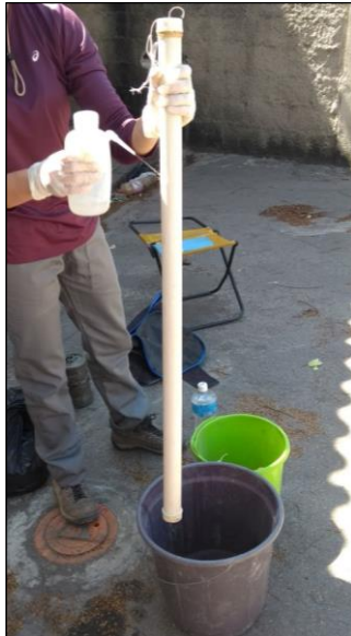
Figura 26. Descontaminação do tarugo com água destilada e deionizada.
