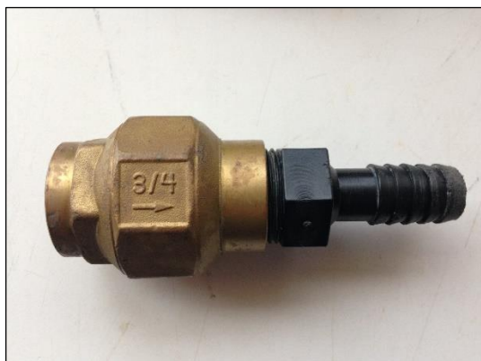
Figura 14. Exemplo de válvula de pé de 3/4" utilizada para o desenvolvimento dos poços da área de estudo.
